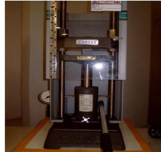
Figura 4. Prensa Hidráulica CARVER
