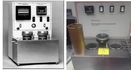
Figura 2. Consistómetro Atmosférico 165 AT
