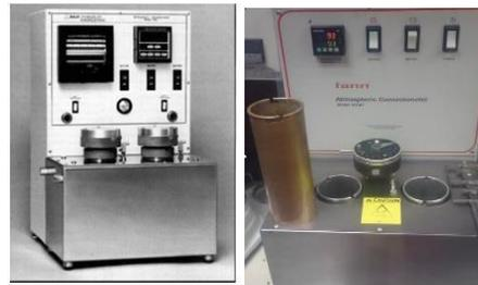
Figura 2. Consistómetro Atmosférico 165 AT
