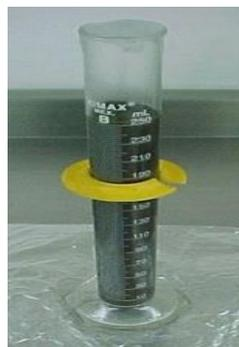
Figura 11. Prueba de Estabilidad en una Lechada de cemento fraguada.
