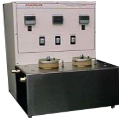
Figura 3. Consistómetro Atmosférico.
